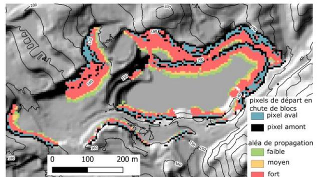
Figure 2 : Exemple des résultats fournis par ELANA à partir du MNT 5 m d'une ancienne carrière et d'un raster de même dimension où l'utilisateur déclare les pixels de départ en chute de blocs. ELANA classe les pixels de départ en pixels « amont » et « aval » et permet d'obtenir le raster des zones de propagation faible, moyenne et fortes à partir des lois empiriques proposées.
