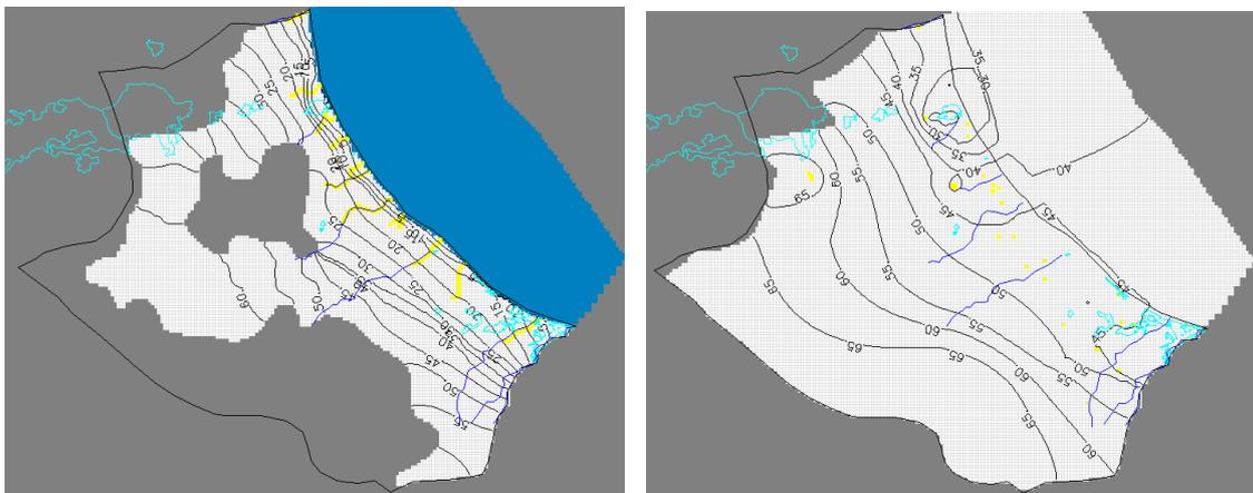
Figure 5: Cartes piézométriques simulés de la couche 1 (à gauche) et de la couche 2 (à droite) après calage du régime permanent
