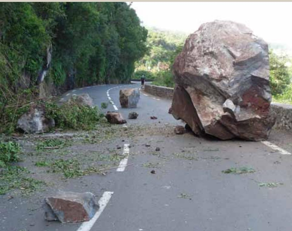
**Photo 1 : Île de la Réunion, effondrement d'un bloc de 30 tonnes sur la RN 2 à Saint-Joseph en septembre 2010.**
