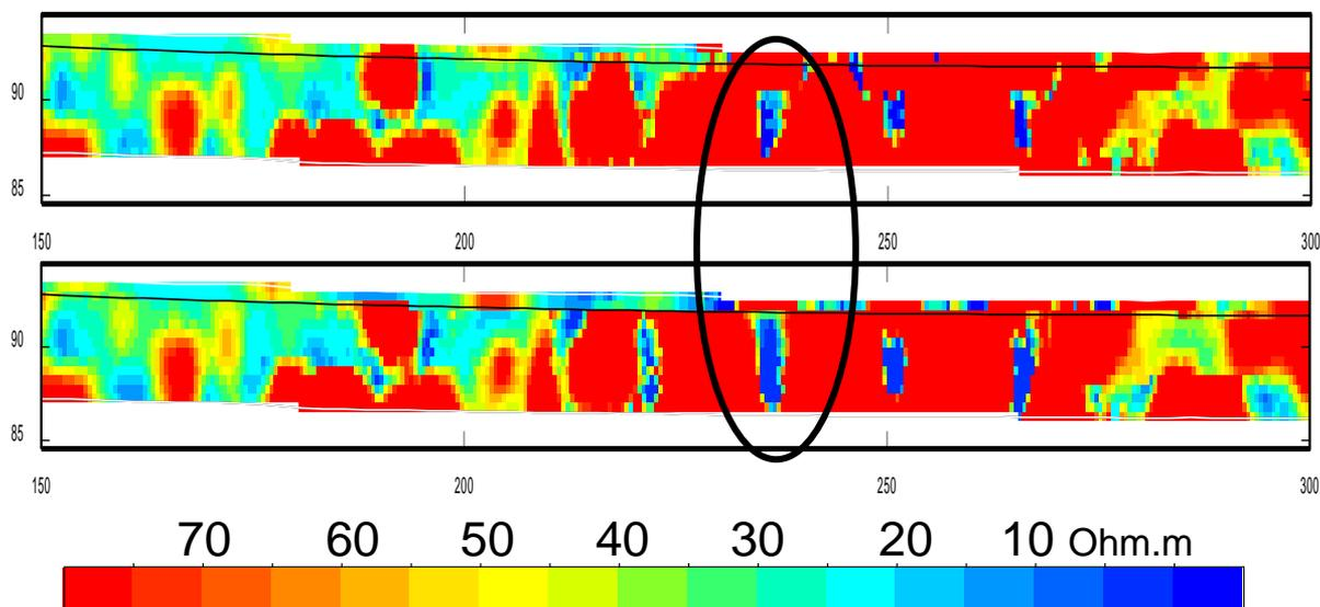
Figure 6 : Interpolation de la résistivité sans tenir compte de l'interface géologique (figure du haut) et en tenant compte d'une interface alluvions-miocènes (figure du bas) – L'interface alluvions/miocène est représentée par le trait noir – axe Z dilaté
