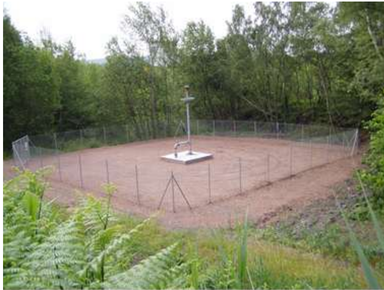
Figure 4 : Exemple de sondage de décompression
